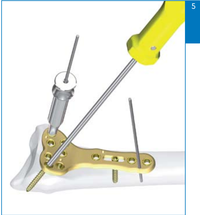
Inserire la vite con il cacciavite esagonale Ø 2,0 mm (S24)
